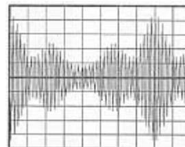
Oscillogramme 3: tension démodulée avec composante continue  $u_{BM}$
