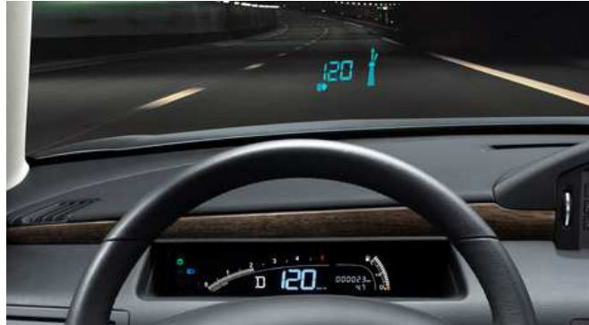
Figure 1. Vue du tableau de bord d'un véhicule muni de l'affichage tête haute
