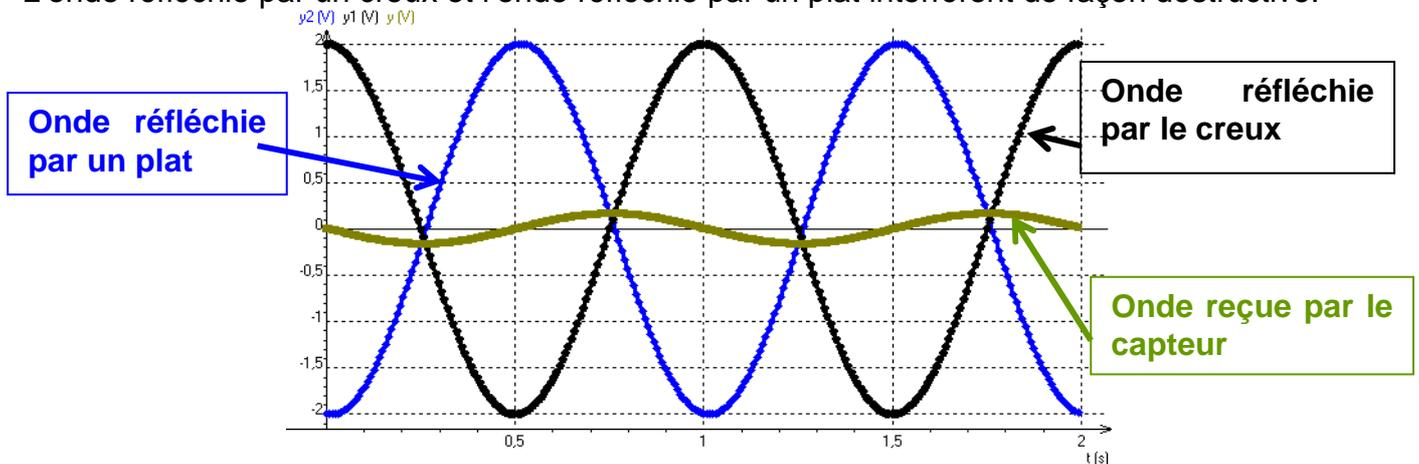
1.4.5. Le signal reçu par le capteur est minimal. Les ondes sont en opposition de phase.
