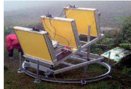
Télescope permettant la détection des muons, placé au bas de la Soufrière, volcan actif de Guadeloupe.
