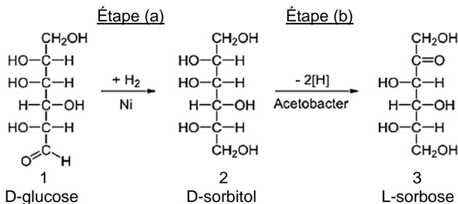
L'étape (a) est l'hydrogénation du D-glucose en D-sorbitol à l'aide d'un catalyseur : le nickel de Raney. L'étape (b) est l'oxydation par fermentation microbienne du D-sorbitol en L-sorbose. Des étapes ultérieures non détaillées ici permettent d'obtenir la vitamine C.
