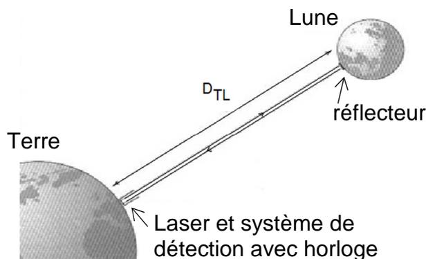
Le principe de la mesure est de déterminer la durée  $T$  d'un aller-retour d'une impulsion LASER émise du sol terrestre vers un réflecteur lunaire composé de nombreux prismes qui jouent le rôle de miroir. La lumière est réfléchiée dans la même direction que le rayon lumineux incident. On en déduit la distance  $D_{TL}$  séparant la Terre de la Lune.
