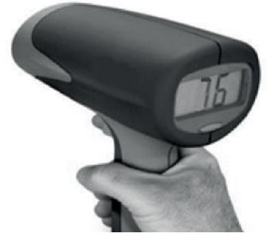
Figure 2. Radar portatif utilisé lors de la mesure de la vitesse (indiquée en \text{km.h}^{-1} ).
